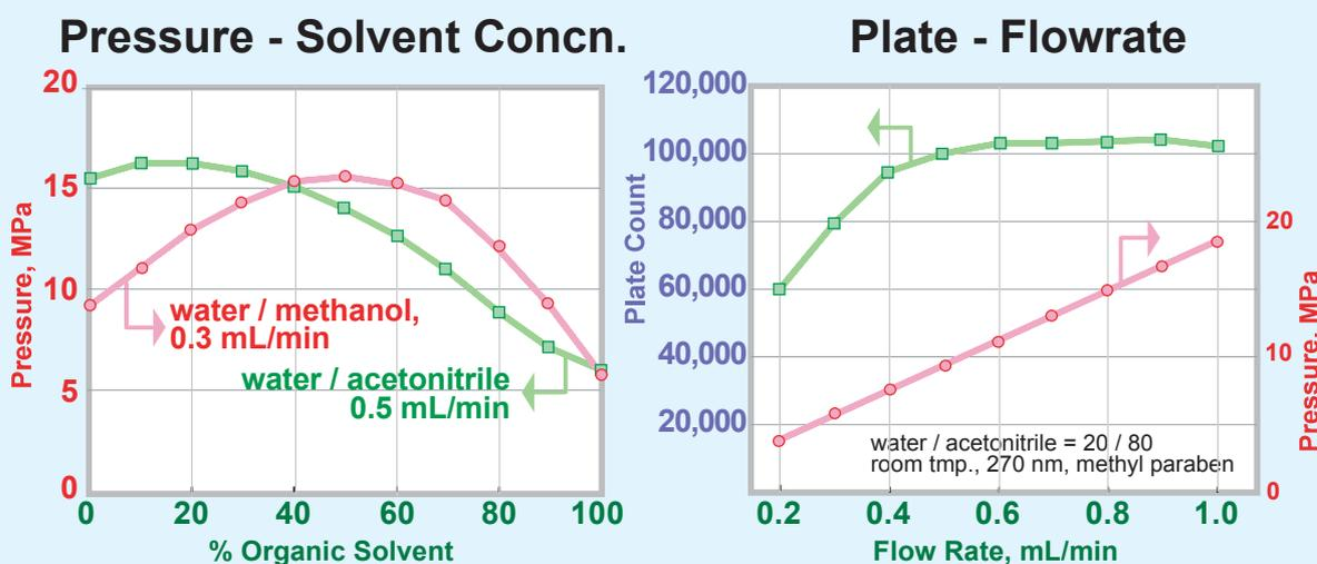
Cadenza CD-C18, 500 x 4.6 mmカラムは、理論段数10万段の高性能カラムです。しかし、3  $\mu$ m粒子のカラムであるため、4.6 mm内径カラムで一般的な流量 1 mL/minで使用すると圧力が高く使いづらくなります。そのため、500mmカラムでは従来のカラムよりも流量を下げる必要があります。
